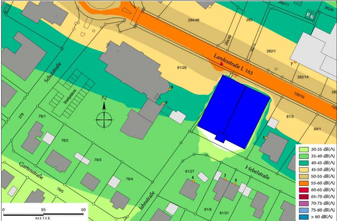
ABBILDUNG 6 Isophonenplan der Lärmimmissionen durch den induzierten Verkehr, tagsüber.
