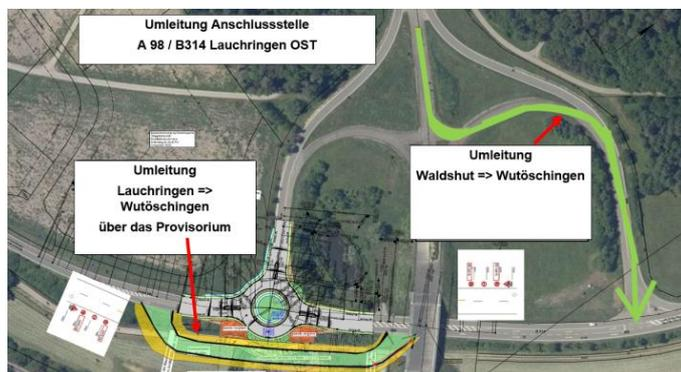
Der Verkehr in Fahrtrichtung Lauchringen/Wutöschingen wird über ein neu erstelltes Provisorium an der Baustelle vorbei geleitet. Die Verkehrsteilnehmer aus Richtung Waldshut kommend, werden über die Ostrampe umgeleitet.
